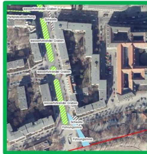
Maßnahmen an der Oberfläche zur Retention und Abflussleitung
