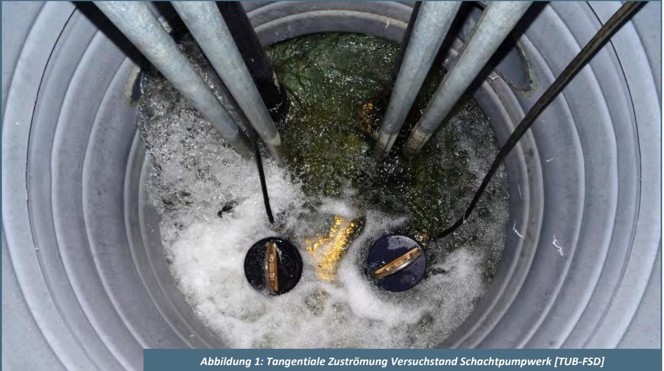
Abbildung 1: Tangentiale Zuströmung Versuchstand Schachtpumpwerk [TUB-FSD]
