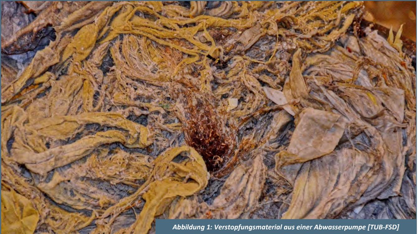
Abbildung 1: Verstopfungsmaterial aus einer Abwasserpumpe [TUB-FSD]
