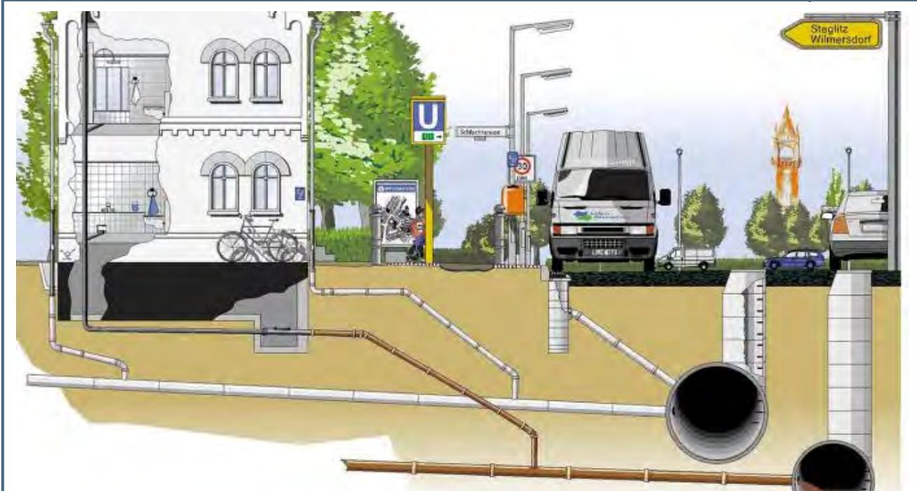
Abbildung 1: Schema einer Mischkanalisation [BWB]
