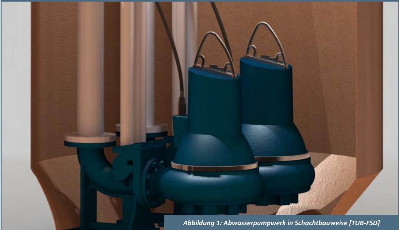
Abbildung 1: Abwasserpumpwerk in Schachtbauweise [TUB-FSD]
